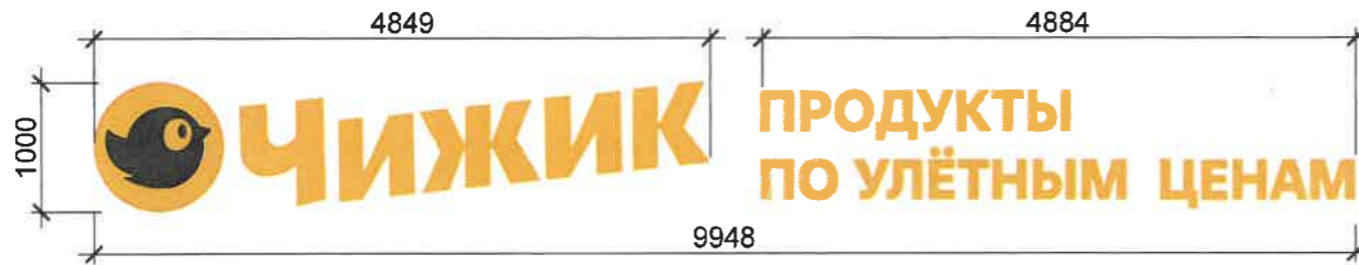
Вывеска "Чижик" на главном фасаде (поз. 1*)
