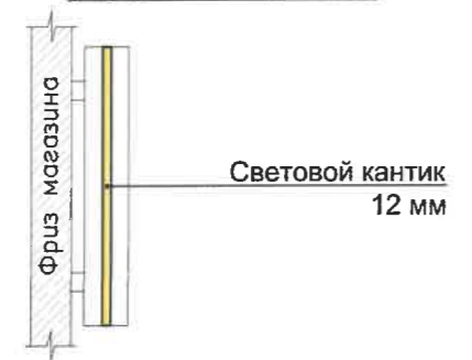
Схема подсветки фасадной вывески (внутренняя подсветка)
