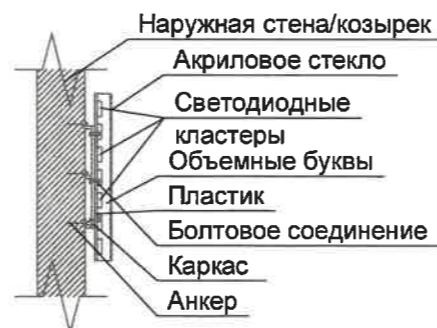
Узел крепления средств размещения информации (поз. 1,4)
