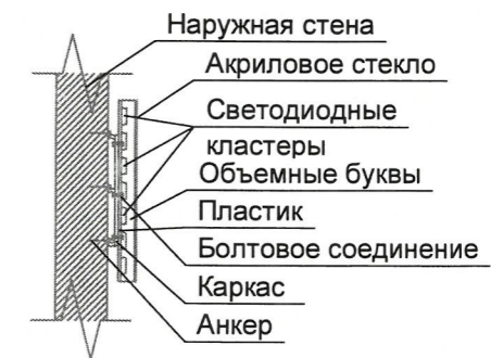
Узел крепления средств размещения информации (поз. 1)
