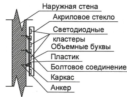
Узел крепления средств размещения информации (поз. 1)
