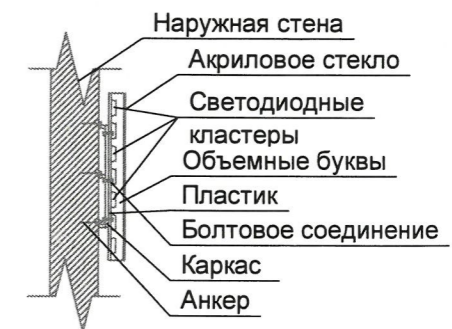
Узел крепления средств размещения информации (поз. 1)
