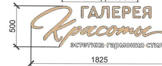
Габариты вновь устанавливаемой вывески, в мм (поз. 2 ведомости)
