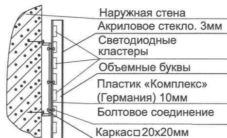
Схема крепления вывески 2
