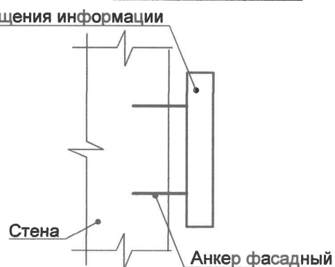
Схема крепления средств размещения информации к фасаду
