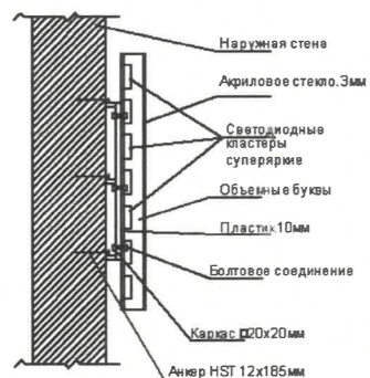
Узел крепления средств размещения информации
