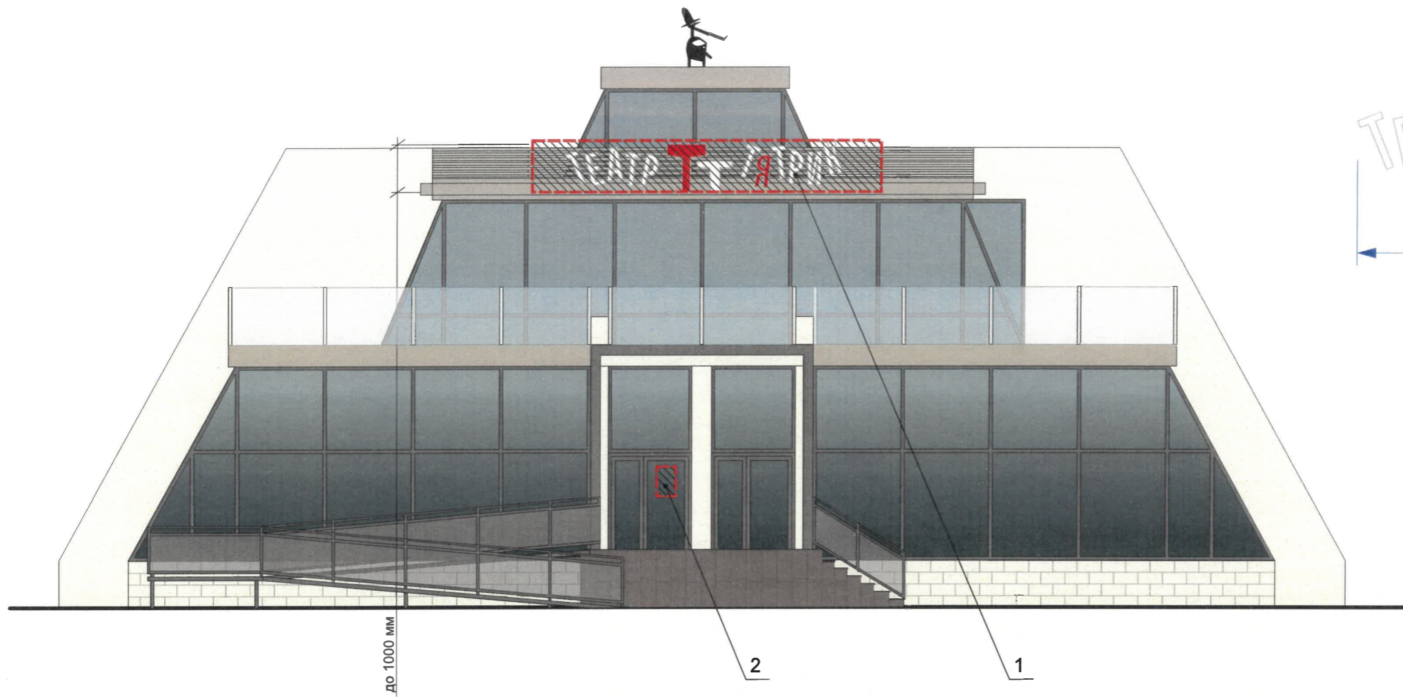
Схема компоновки объемных букв и/или логотипов, относительно оси и места размещения средств размещения информации, поз.1
