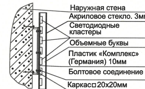
Схема крепления вывески 2
