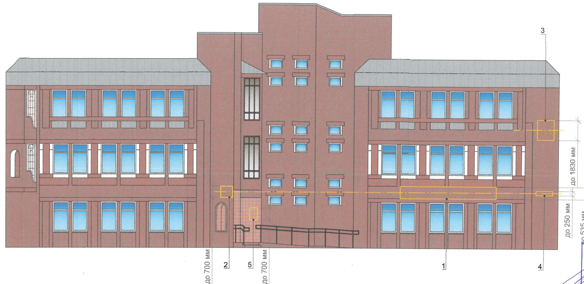
Схема компоновки объемных букв и/или логотипов относительно единой горизонтальной оси размещения объектов
