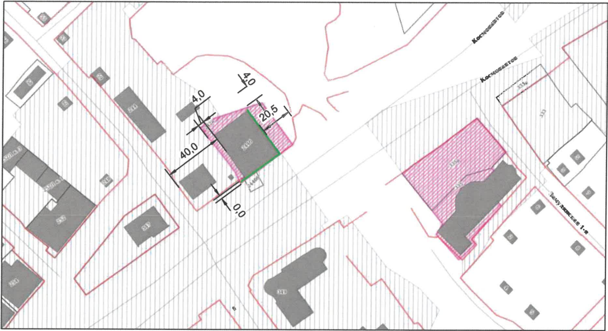
План координационных осей здания
