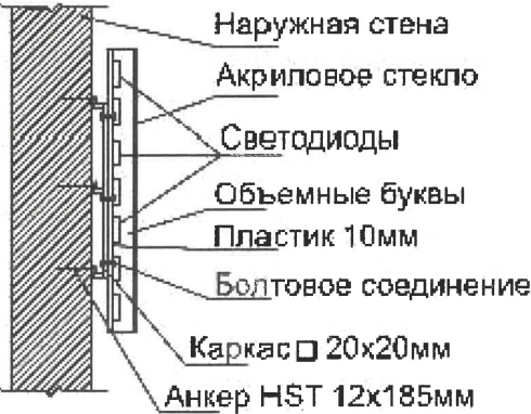
Узел крепления средств размещения информации на стене здания
