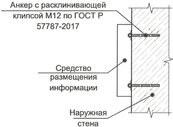
Узел крепления средств размещения информации (поз. 1) на фасад
