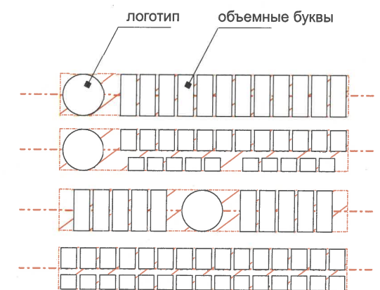
Схемы компоновки объемных букв и/или логотипов, относительно оси и места размещения средств размещения информации
