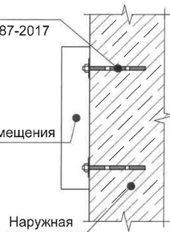
Узел крепления средств размещения информации (поз. 1) на фасаде
