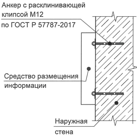
Узел крепления средств размещения информации (поз. 3) на фасаде
