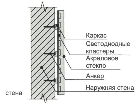
Пример узла крепления средств размещения информации, рекламных конструкций
