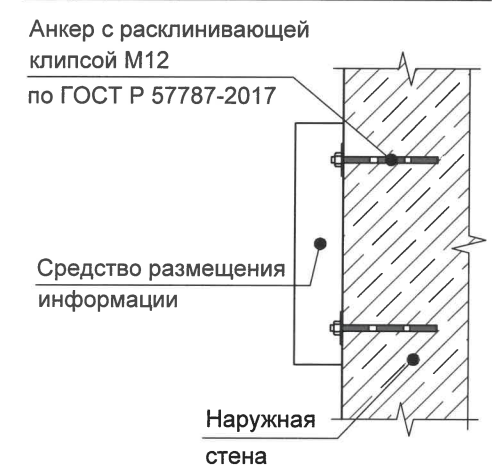
Узел крепления средств размещения информации (поз. 3) на фасаде
