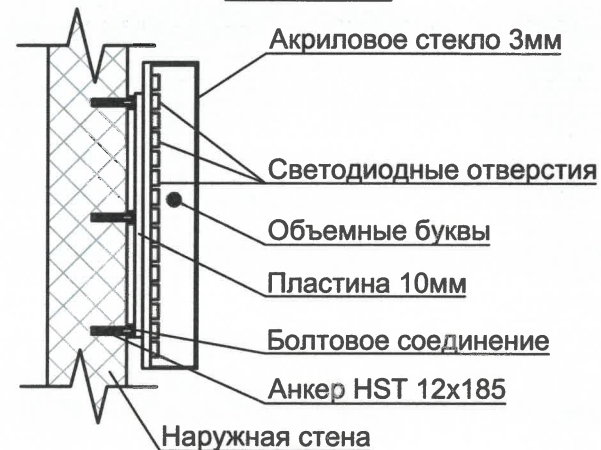
Узел крепления средств размещения информации
