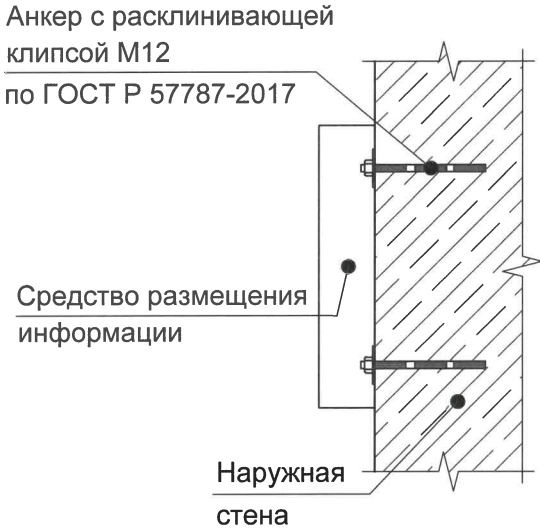
Узел крепления средств размещения информации (поз. 1) на фасаде
