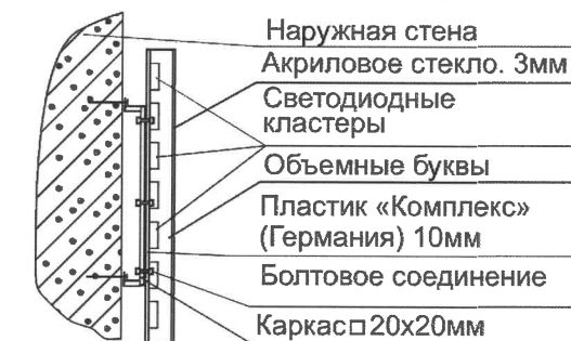
Схема крепления вывески 2
