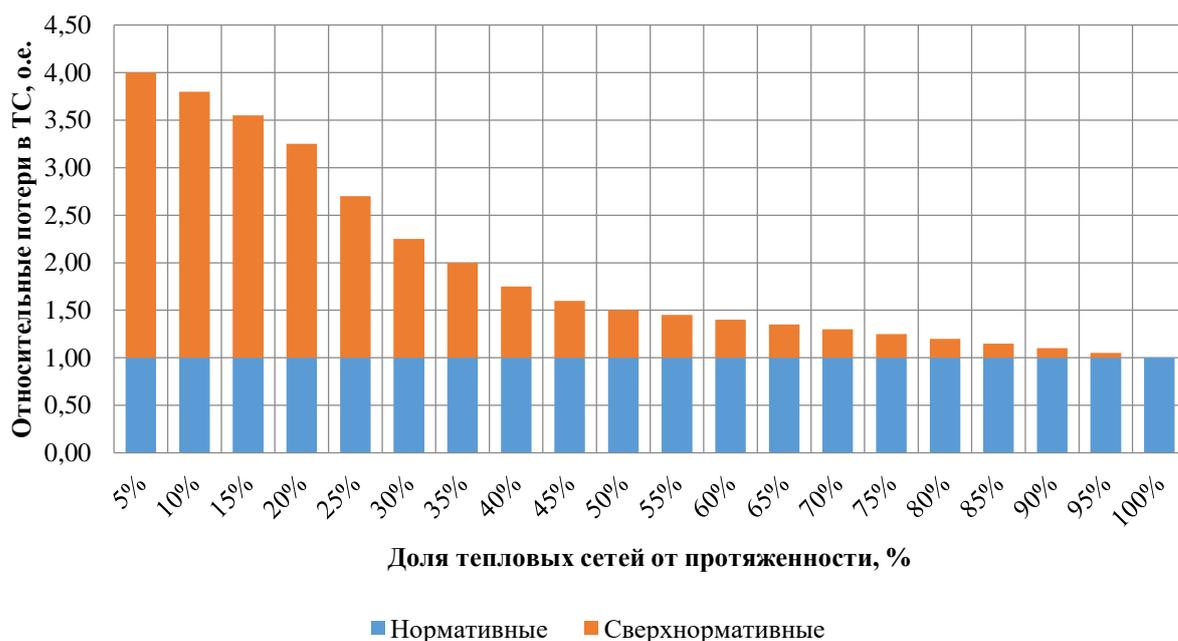
**Рисунок 36 – Условное распределение нормативных и сверхнормативных потерь в тепловых сетях, о.е.**
