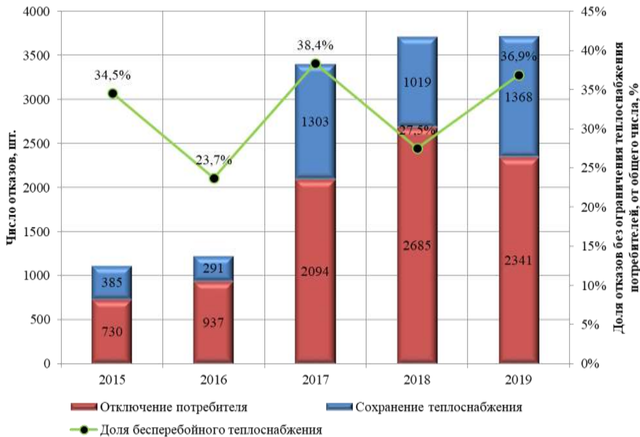
Рисунок 44 – Влияние инцидентов на тепловых сетях на отключение конечных потребителей тепловой энергии
