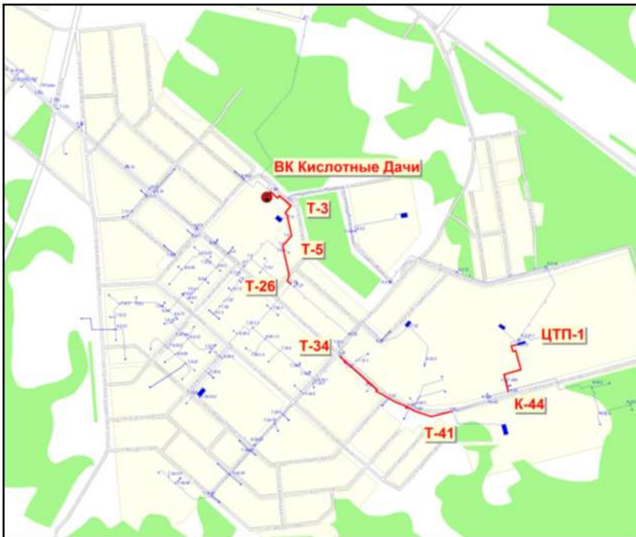
Рисунок 58 - Трассировка магистралей от VK Кислотные Дачи ООО «ПСК», подлежащих реконструкции
