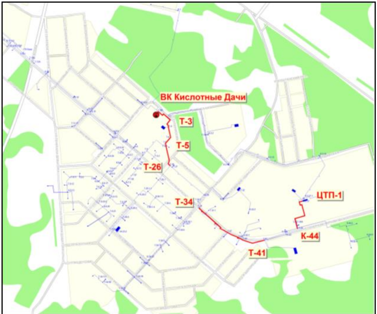
Рисунок 58 - Трассировка магистралей от ВК Кислотные Дачи ООО «ПСК», подлежащих реконструкции
