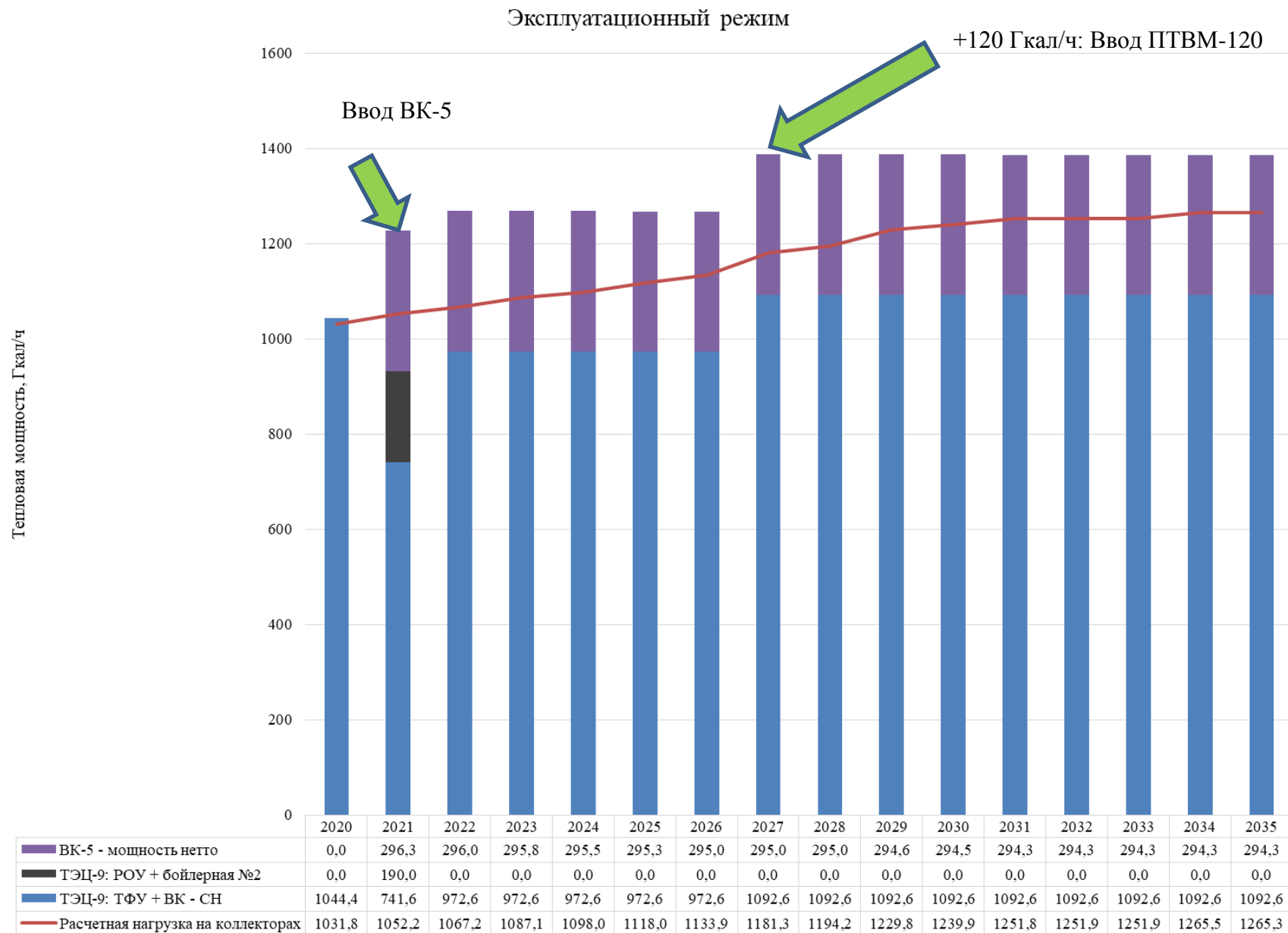
Рисунок 7 – Баланс тепловой мощности и подключенной нагрузки ТЭЦ-9 + ВК-5 на расчетный период в эксплуатационном режиме
