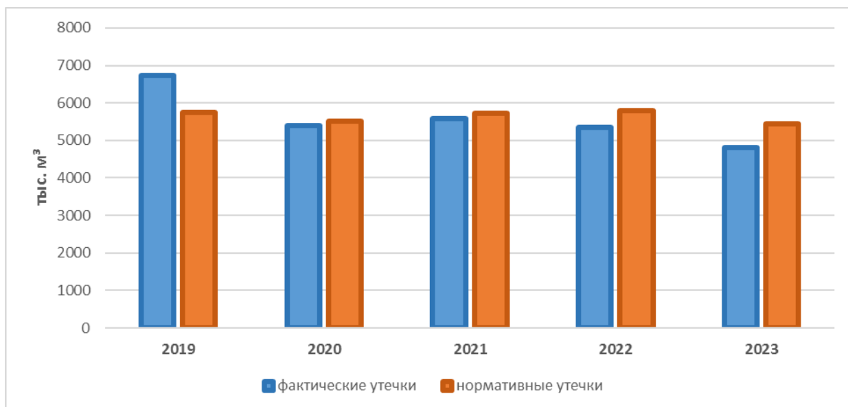
Рисунок 3.62 – Фактические потери теплоносителя
