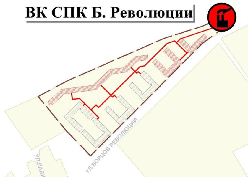
Рисунок 3 - Графическое отображение тепловых сетей планируемых для строительства в период 1-го расчетного срока схемы теплоснабжения микрорайона по ул. Борцов Революции, 1а
