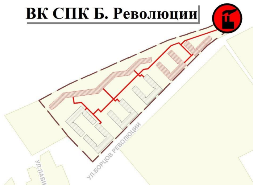
Рисунок 3 - Графическое отображение тепловых сетей планируемых для строительства в период 1-го расчетного срока схемы теплоснабжения микрорайона по ул. Борцов Революции, 1а
