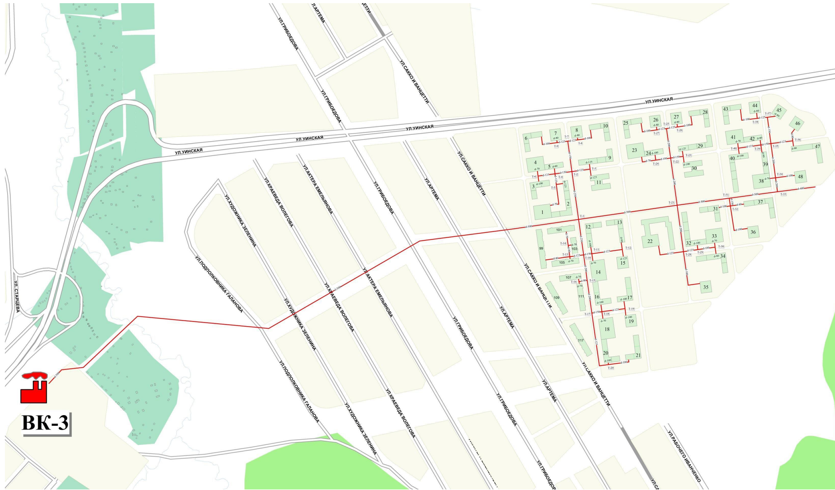
Рисунок 1 - Ситуационный план развития системы теплоснабжения 1-ой и 2-ой очереди строительства микрорайона «Ива-1»
