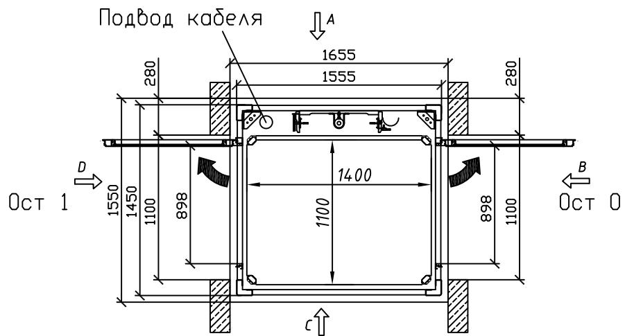
Схема устройства машинного помещения
