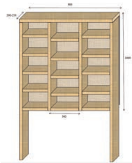
Рис. 10. Схема устройства габариты (приблизительные) каркаса стационарного домика для насекомых
