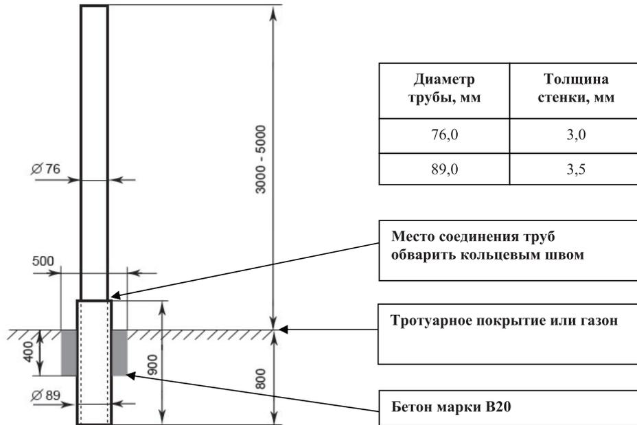
2.2. Высота опор выбирается согласно дислокации дорожных знаков с соблюдением требований ГОСТ Р 52289-2004 и может составлять от 3 до 5 м от верхней кромки опоры знака до поверхности дорожного покрытия. Точная высота указывается в заявках Заказчика.
