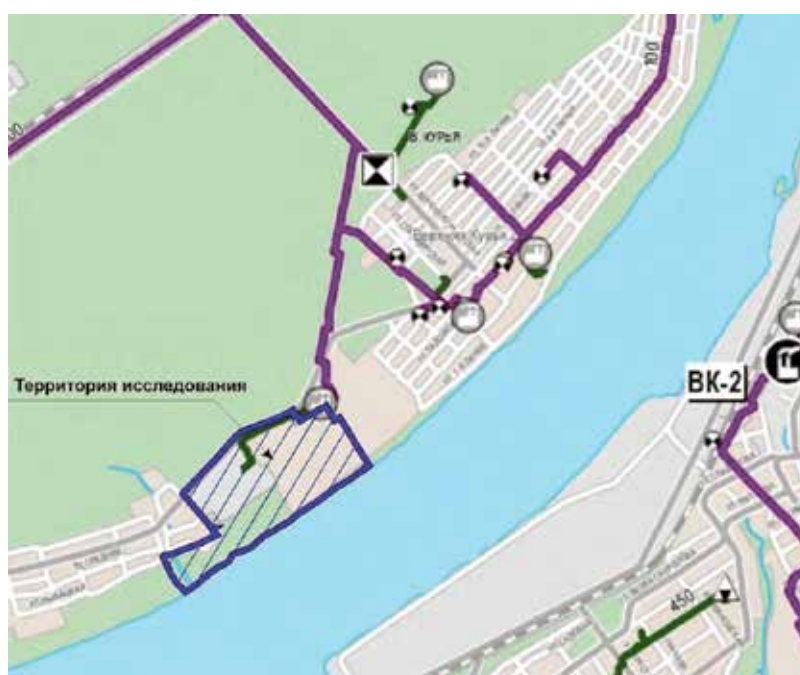
Рисунок 5.6-3 Схема газоснабжения. Современное состояние. Из материалов Генерального плана города Перми.
