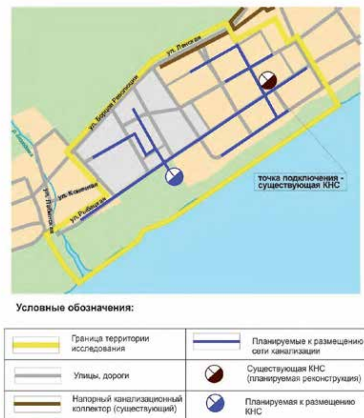
Рисунок 6.3-31 Мероприятия. Схема сетей бытовой канализации
