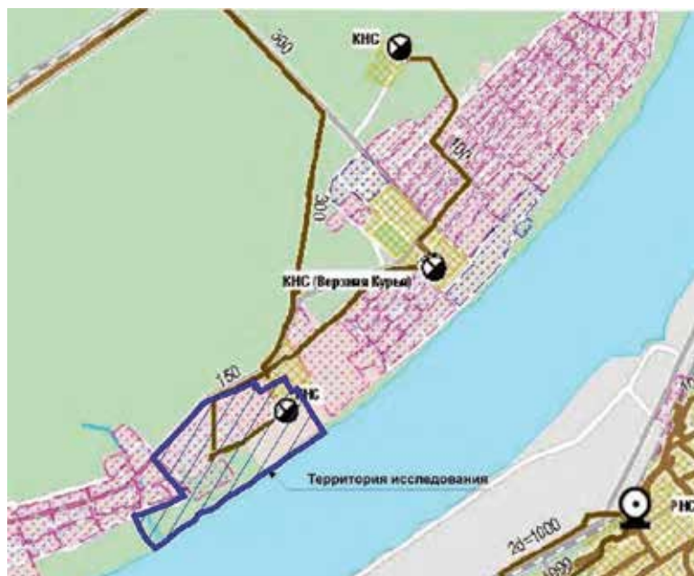
Рисунок 5.6-1 Схема водоотведения. Современное состояние.
