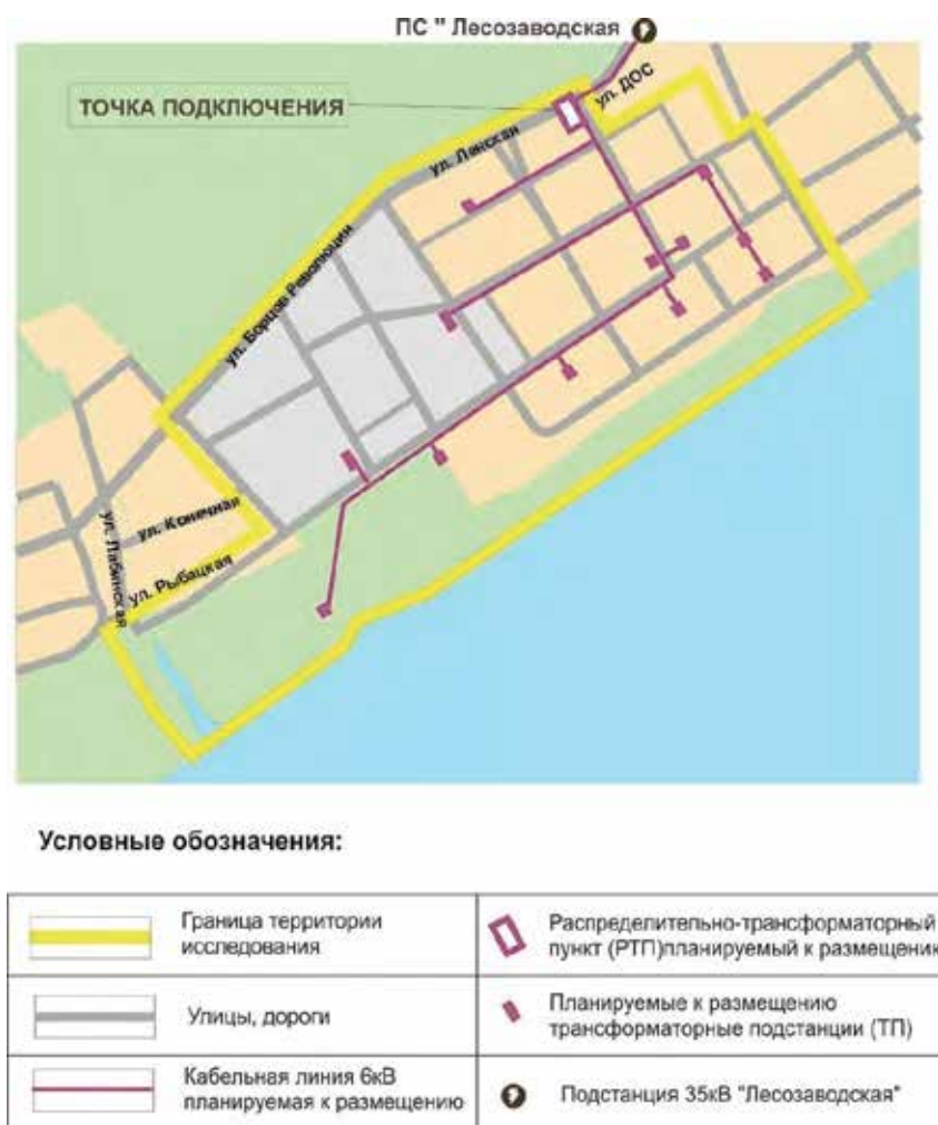
Рисунок 6.3-39 Мероприятия. Схема сетей электроснабжения
