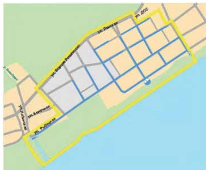
Рисунок 6.3-33 Мероприятия. Схема сетей дождевой канализации
