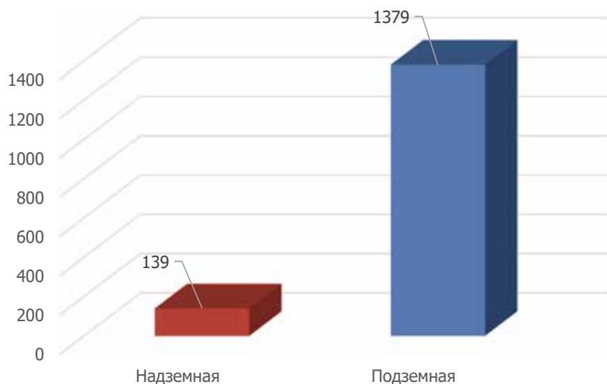
Рисунок – Количество отключений абонентов в отопительный период 2015-2016 гг. по типу прокладки
