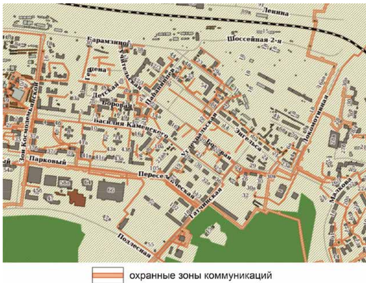
Рис. 21. Охранные зоны инженерных сетей и объектов
