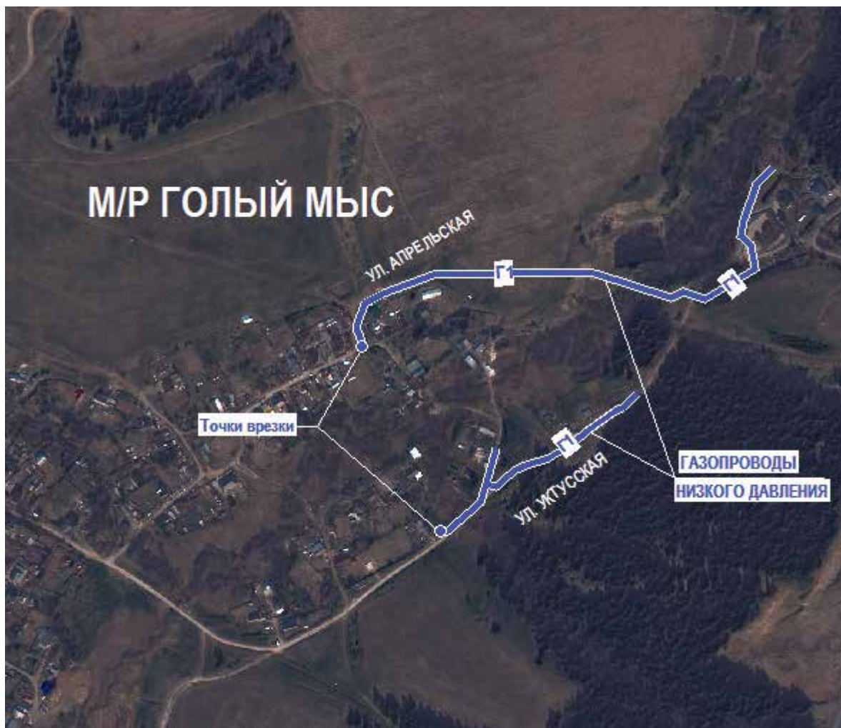
Рисунок 18. Схема планируемого размещения объектов системы газоснабжения в микрорайоне Голый Мыс
