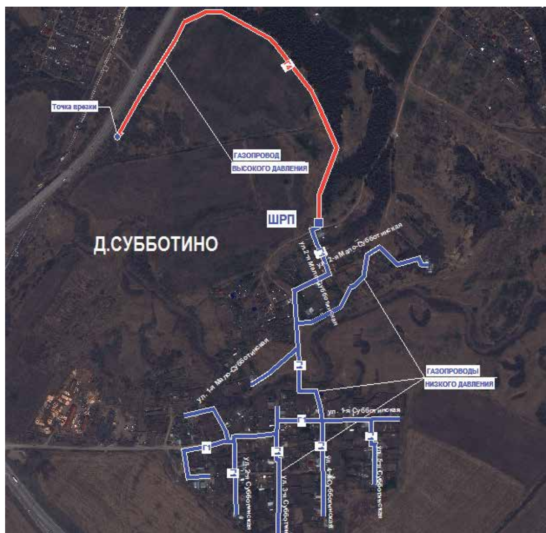
Рисунок 21. Схема планируемого размещения объектов системы газоснабжения на территории Субботино
