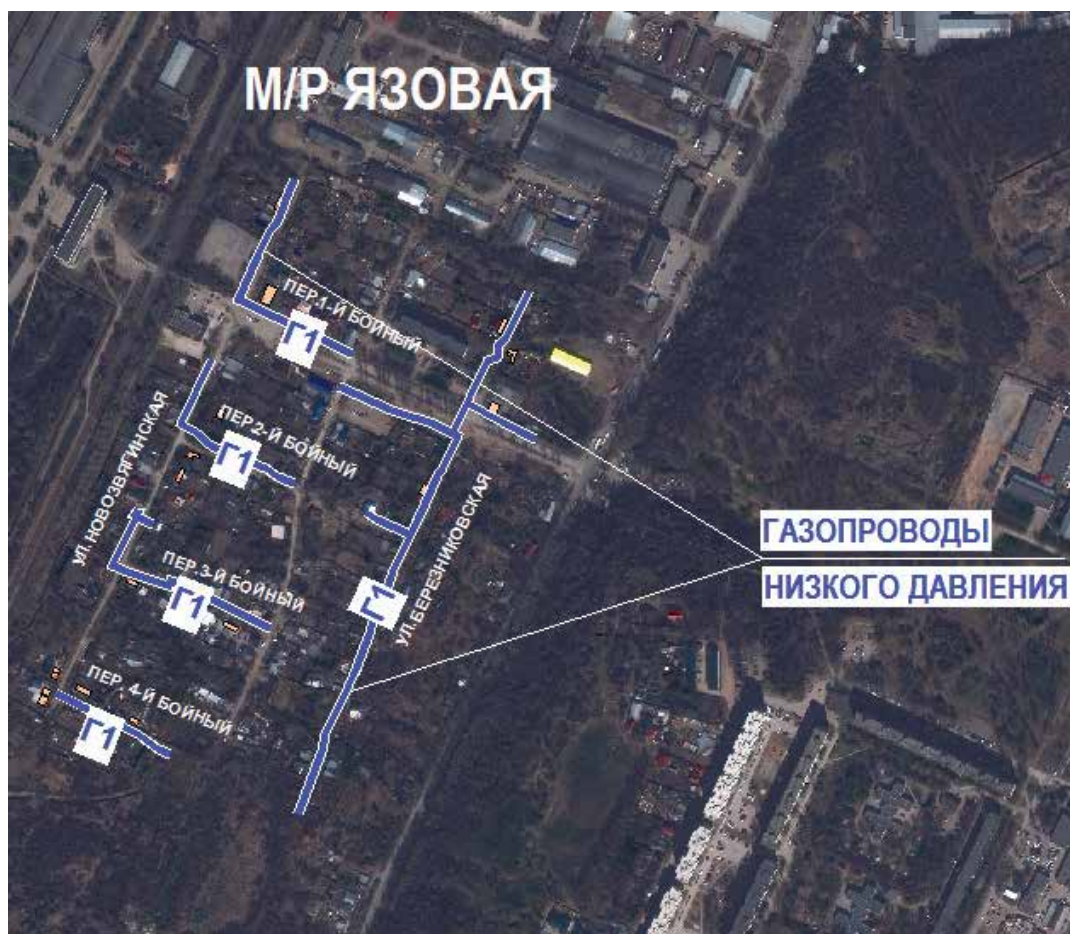
Рисунок 19. Схема планируемого размещения объектов системы газоснабжения в микрорайоне Язовая
