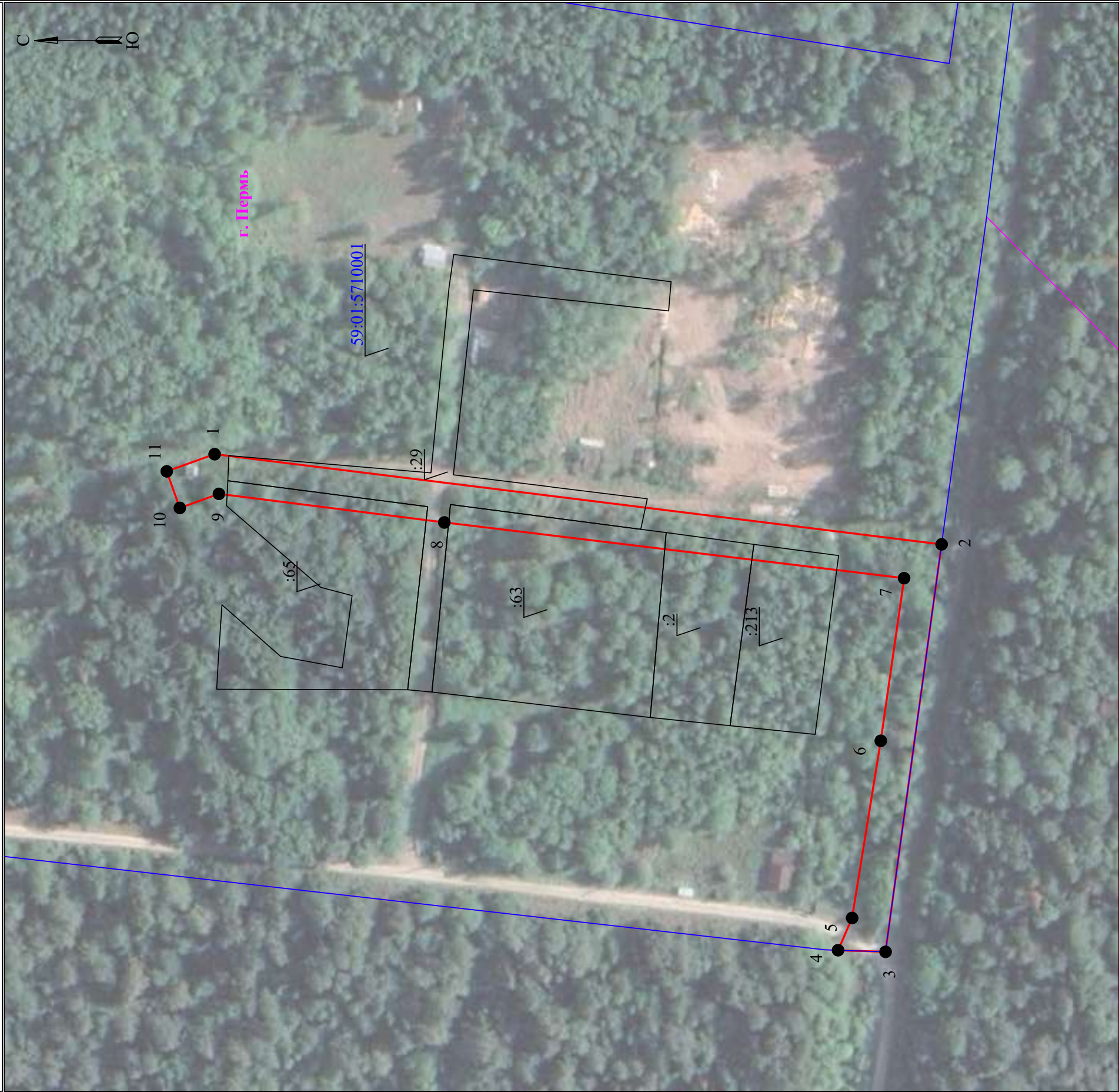
Схема расположения границ публичного сервитута для эксплуатации объекта электросетевого хозяйства ВЛ-10кВ Сафроны ПС Сафроны отпайка к КТП-6770 (наименование объекта)
